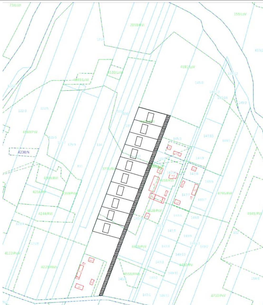
Rysunek. Planowane zagospodarowanie terenu z podziałem na 10 działek budowlanych o powierzchni 1000 m 2 (źródło: opracowanie własne, podkład mapowy https://mapy.geoportal.gov.pl/imap/ )
